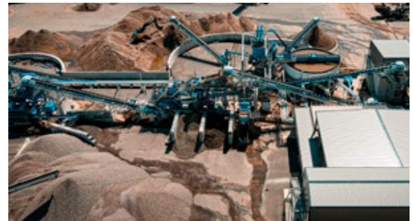
Die R-Gestein Niederrhein Nassaufbereitungsanlage ermöglicht eine höherwertige Fraktionierung der mineralischen Abfälle.
