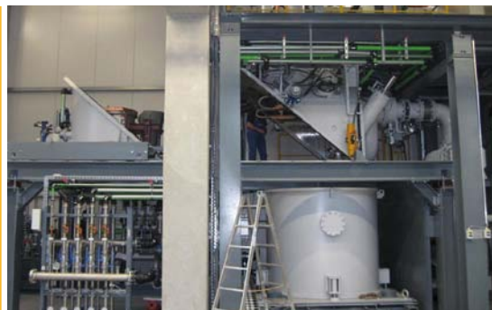
■ Der neue material- und energieeffiziente Schwerkraftgusssofen von TITAL.
