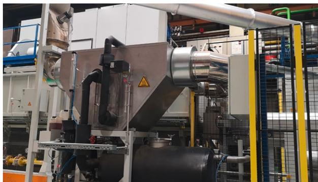
Für die Vorwärmung der Aluminiumbolzen werden die Abgase durch einen Wärmetauscher geführt, wo die Wärme über eine große Fläche an Wasser abgegeben wird.
