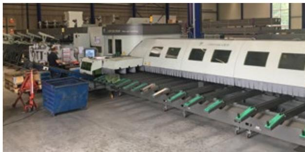
Dank des Aufbaus der Rohrlaserschneidanlage kann die Metrio GmbH heute bis zu zwölf Meter lange Metallrohe verarbeiten.
