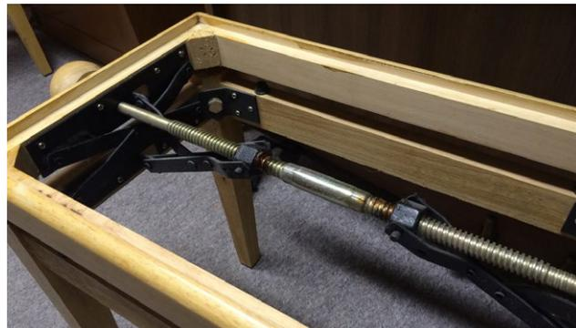
Eine herkömmliche Klavierbank (siehe Foto) wird aus 80 Teilen gefertigt, bestehend aus Holz, Metall, Kunststoff und Polstermaterial, die hergestellt und bearbeitet werden müssen.
