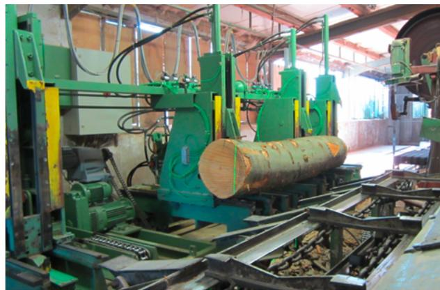
Dank moderner Spanntechnik und höherer Transportleistung konnte die Einschnittkapazität der Bandsägeanlage erhöht werden.
